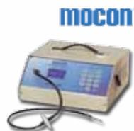
Equipo para análisis de empaques flexibles y rígidos, mediciones de permeabilidad, W.V.T.R., oxígeno CO<sub>2</sub> y medición de fugas, espacio libre, etc.
