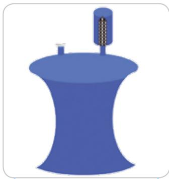
Figura 2. Mal dimensionamiento del venteo.
