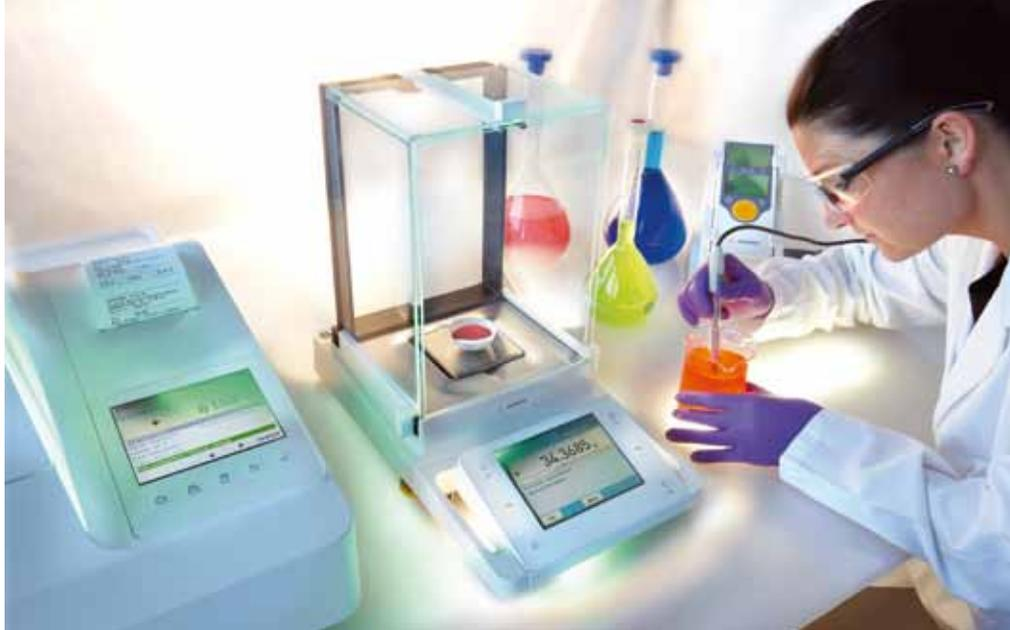
Esto significa que una muestra de 200 g pesa 0.0025 g menos en una balanza inclinada. ¡Siempre nivele su instrumento mediante el indicador de nivel como guía, de acuerdo con los efectos de la gravedad en la precisión del pesaje!
