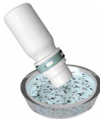
Imagen 5. Se desafía para el sistema con la punta sumergida en la suspensión de bacterias.
