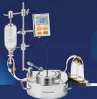
Sistema completamente cerrado para pruebas de esterilidad de productos farmacéuticos, o sistemas reutilizables para pruebas de esterilidad de soluciones de inyección.
